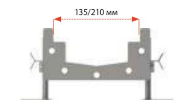
Части желоба с уклоном дна можно конфигурировать до максимальной длины 12 м одной линии в рамках производства под заказ.
