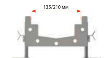
Угловые части желоба с уклоном дна можно конфигурировать с учётом комплекта самотечного водоотведения на основании требований проекта.
